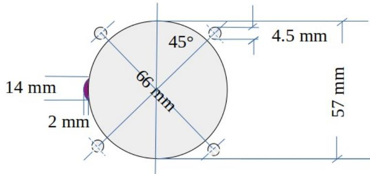
Bei besonders dicken Instrumenten-Panels mit einer Dicke von mehr als 2 mm, muss seitlich auf halber Höhe für den Rotary Knopf eine kleine vorzugsweise halb-runde Nische mit einer Breite von 2 mm und einer Höhe von 14 mm geschaffen werden, dies ist unten Magenta gezeigt. Im Normalfall ist das nicht notwendig, da Standard Panels ca. 2 mm Stärke aufweisen.
