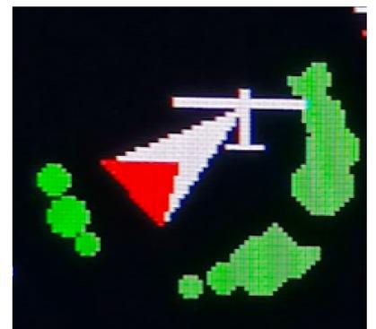
Ist kein Magnetsensor vorhanden, wird als Referenz der Kurs über Grund von einem eventuell angeschlossenen Flarm oder GPS verwendet.
