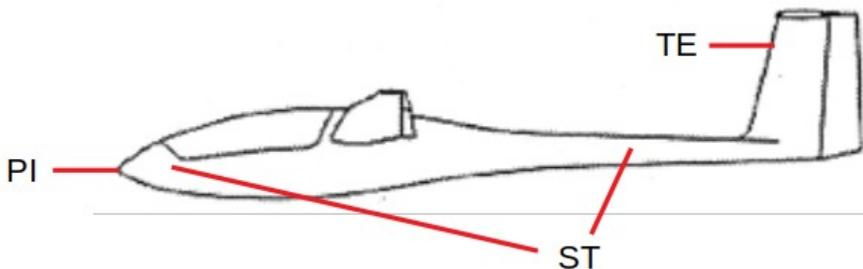
Die Drücke sind normalerweise Hersteller seitig hinter dem Instrumenten Panel verschlaucht, und entweder bereits passend für ein Vorgängergerät verlegt, oder können an mechanischen Instrumenten mit Hilfe eines T-Stücks abgenommen werden. PI und ST liegen dabei am Fahrtmesser an, TE in der Regel an einem mechanischen Variometer.
