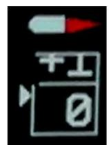
im Setup je nach Modell angepasst werden. Die Anzeige muss dazu im Setup unter /Flap (WK) Indicator/Flap Indicator Option/ [Enable] aktiviert werden. Neben der Anzeige der besten Einstellung, ist mit dem WK Sensor ab Serie 2021 auch die Anzeige der aktuellen WK Stellung grafisch, in Form eines kleinen Hebels möglich. **Weicht die Hebelstellung um mehr als eine Raste ab von der optimalen Klappenstellung, blinkt der Wölbklappenhebel rot.**
