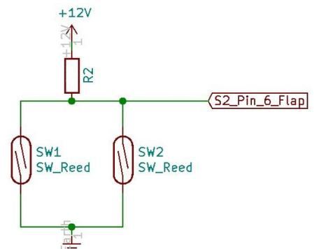
Mit den Optionen „negativ“ kann man auch Kontakte verwenden, welche in Reihe zu legen sind, und dann schließen, wenn die Klappen nicht verriegelt, oder das Fahrwerk nicht vollständig verriegelt ist.
