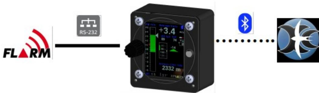
Die RS232 Schnittstelle dient entweder zur Anbindung eines Gerät ohne Wireless (Bluetooth oder WiFi) Support (OpenVario, älterer Kobo), oder zur Anbindung eines FLARM wie oben gezeigt.
