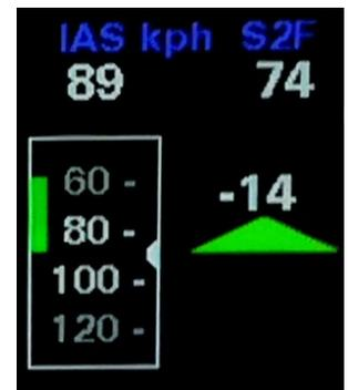
Unterhalb des S2F Wertes ist der eigentliche Sollfahrtgeber in gewohnter Weise. Er zeigt nach unten in roter Farbe für drücken bzw. schneller, und nach oben in grüner Farbe für ziehen oder langsamer. Die Länge des Pfeils misst sich mit der Sollfahrtdifferenz, ab etwa 45 km/h Differenz wird die Spitze des Pfeil abschnitten, der Pfeil wird mit zunehmender Abweichung immer breiter.
