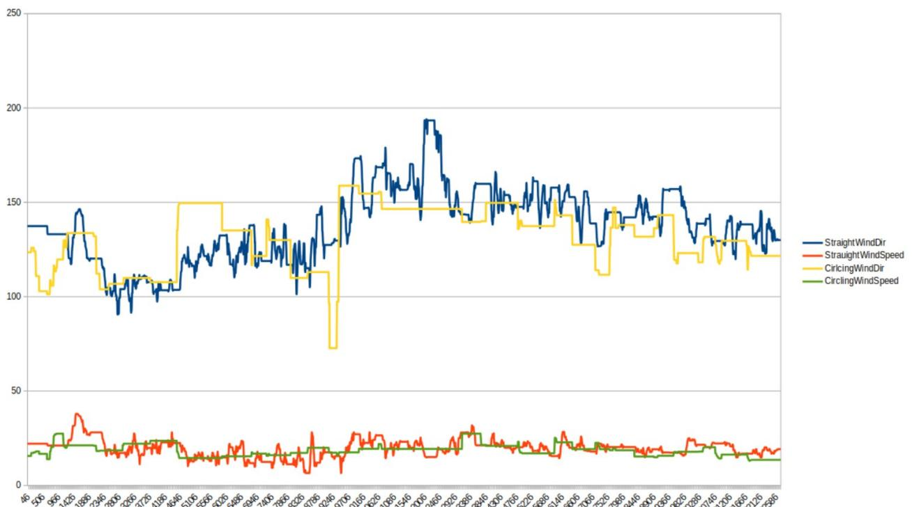
Die Windberechnung im Kreisflug (engl. **Circling**) dagegen ist bereits ausreichend stabil, das Verfahren ist identisch mit XCSoar oder Cumulus, von dem es ursprünglich stammt, und ist bereits freigegeben.
