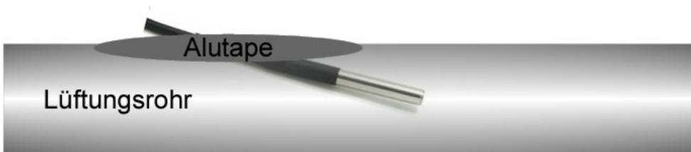
Dies kann auch im Lüftungsrohr erfolgen sofern vorhanden. In dem Falle wird mit einem Cutter-Messer ein kleiner Schlitz geschnitten, der Temperatursensor eingeschoben und z.B. mit Aluminium-Klebetape oder Silikon abgedichtet.
