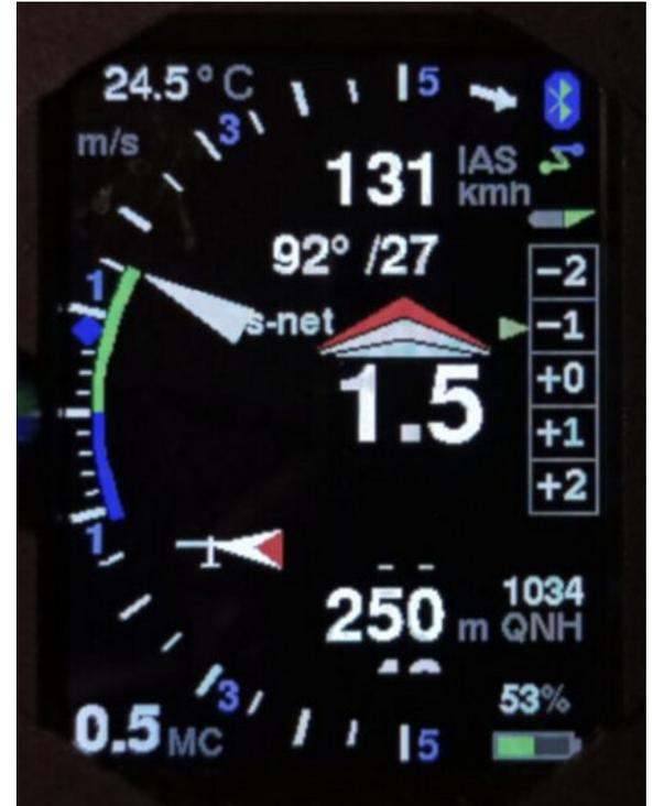
Der Höhenmesser kann in voller Auflösung, oder wie hier gezeigt quantisiert auf 10 Meter in Form einer gleitenden Skala dargestellt werden.
