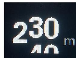
Mit diesem Punkt kann gewählt werden inwiefern die Darstellung des Höhenmessers eine Quantisierung auf ein Intervall von 2-20 Metern (oder 6-60 ft) vornimmt, wie rechts in der Grafik mit 10 Metern gezeigt. Die beiden Ziffern bewegen sich wie auf einer Zählerrad dann nach oben durch (Steigen), bzw. nach unten (Fallen), was die Ablesbarkeit bei in Bewegung befindlicher Flughöhe gegenüber der einfachen Digital-Darstellung deutlich verbessert.
