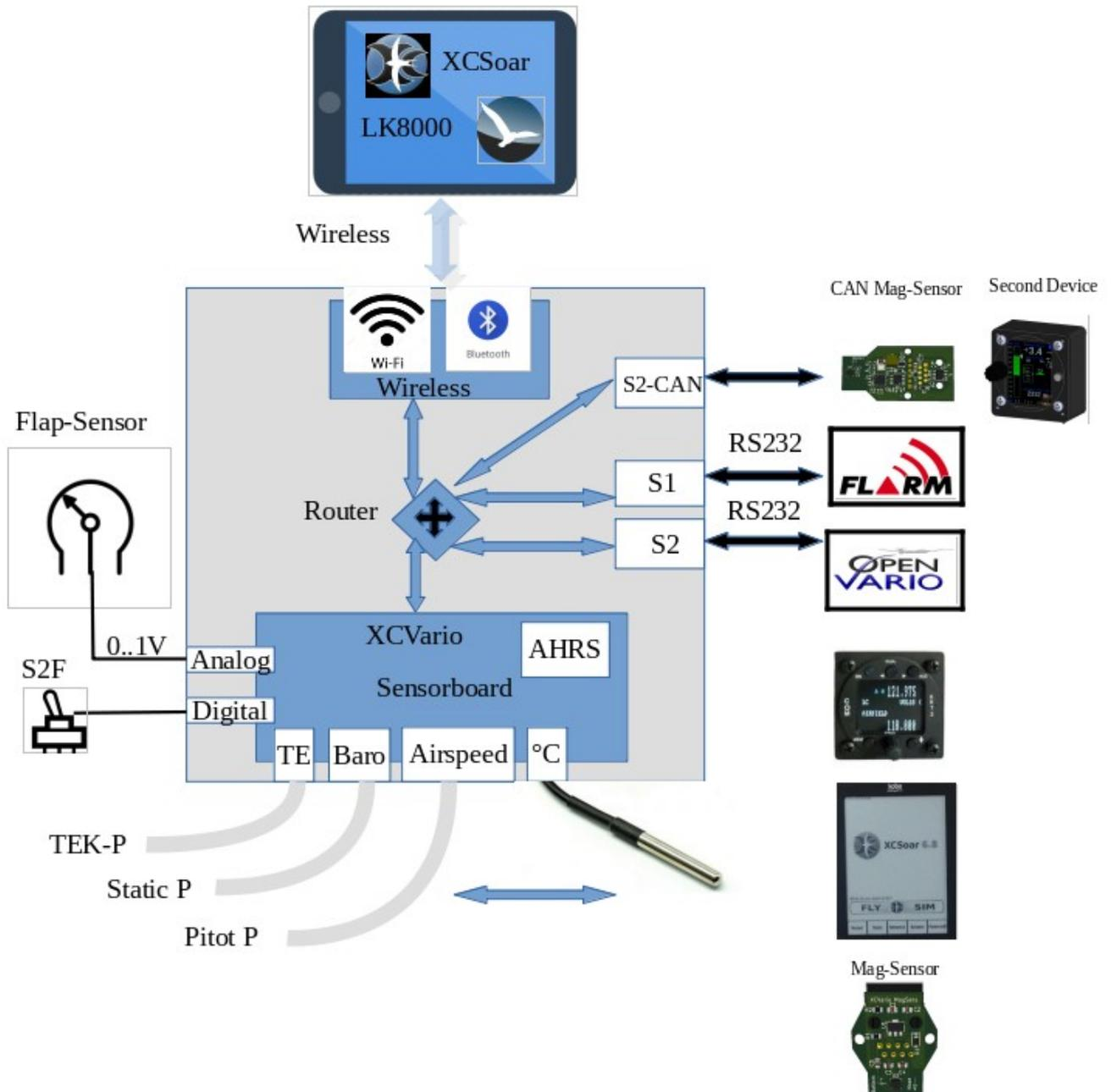
Mit dem WiFi Standard am Wireless Interface, ist es auch möglich mit Geräten ab der Serie 2021 noch ein weiteres Gerät, z.B. ein Funkgerät an der Schnittstelle S2 zu steuern. Mehr dazu im Kapitel zum XCSoar Setup.
